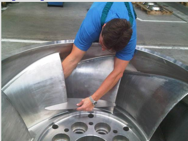
Rozměrová kontrola při přejímce oběžného kola
