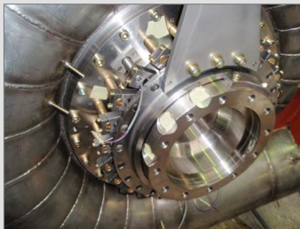
Detailní záběr na částečně smontovaný model turbíny PVE Koyna
