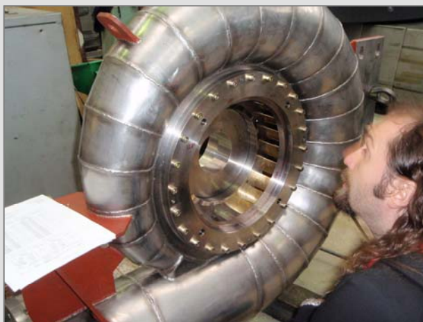
Vizuální kontrola spirály modelu turbíny PVE Koyna ve výrobě
