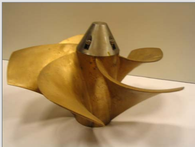
Model nově vyvinuté propelerové turbíny
