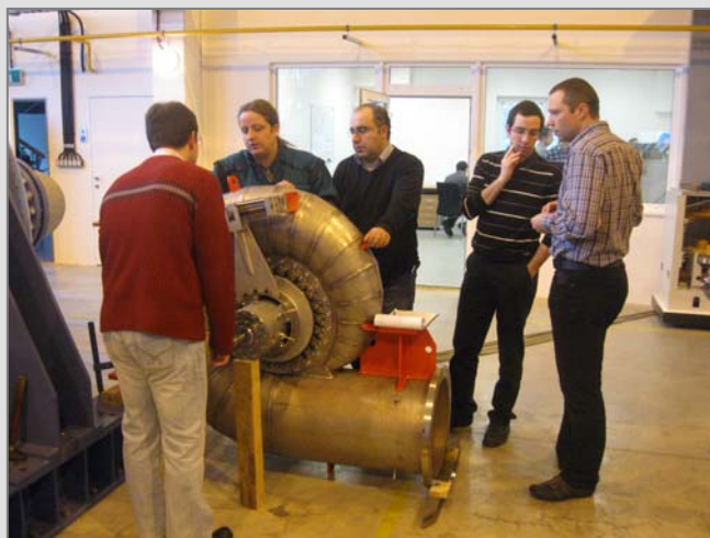
Rozměrová kontrola spirály modelu za účasti zákazníka v průběhu modelového měření
