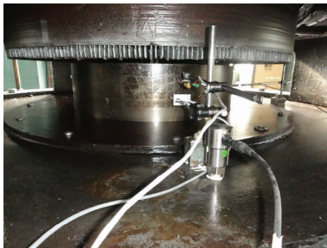
Měření vibrací závěsného ložiska
