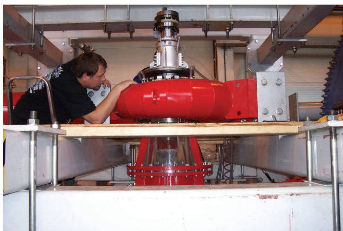
Montáž modelu Francisovy turbíny v hydraulické laboratoři
