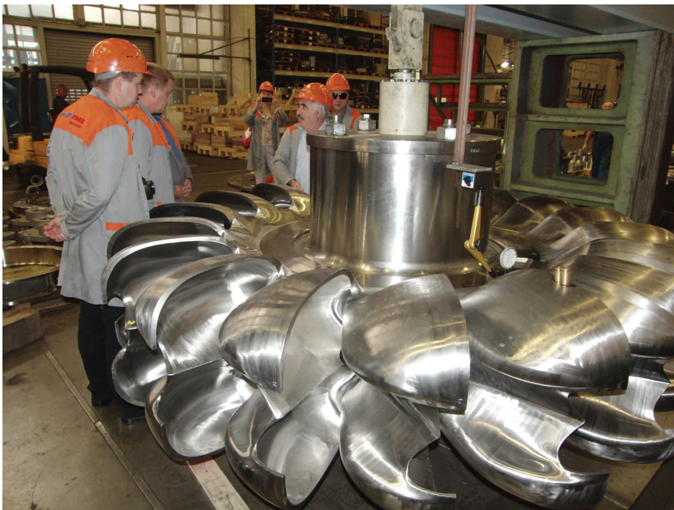
Identické oběžné kolo Peltonovy turbíny pro VE Chrami vyrobené v loňském roce v Litostroj Power v Ljubljani
