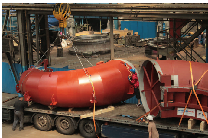
Příprava částí spirály k převozu na stavbu
