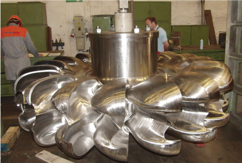
Oběžné kolo Peltonovy turbíny pro VE Chrami 1
