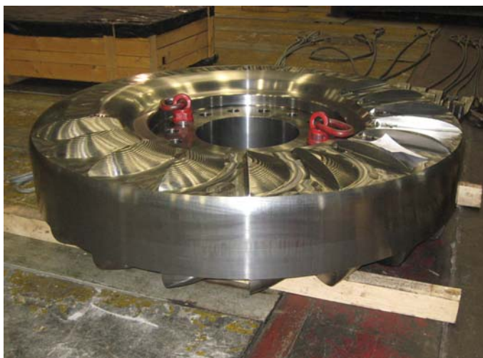
Ve výrobním závodě Litostroj Power začaly práce na opravování oběžných Peltonových kol pro projekt VE Ngoi Hut 2 ve Vietnamu.
