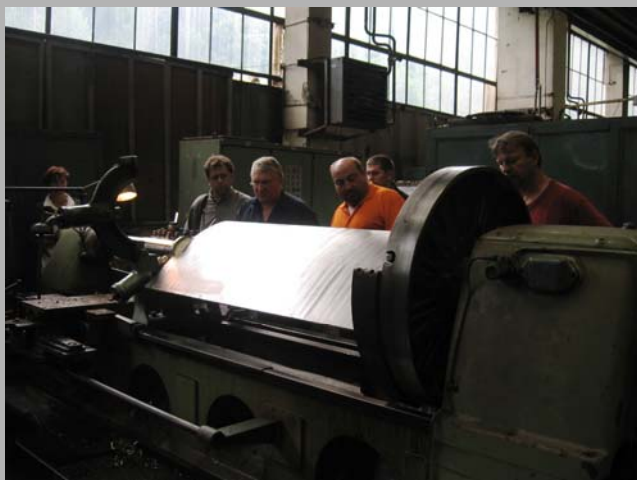
Obr. 2. Kontrola rozváděcích lopat VE Kamýk
