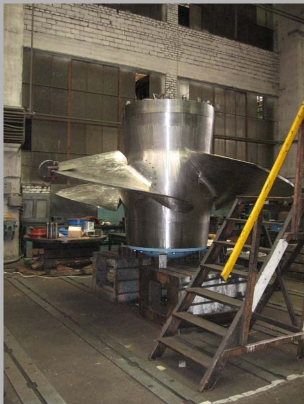
Obr. 6. Tlaková zkouška OK VE Kamýk
