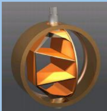
3D návrh nového tělesa rychlozávěrné klapky
